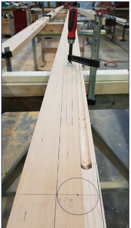
Cette gorge a la même taille tout le long du mât. Le cercle dessiné indique l'emplacement du réa pour le passage de la drisse de grand-voile. (Le réa est la roue à gorge d'une poulie. C'est la partie mobile dans laquelle s'enroule le filin)
