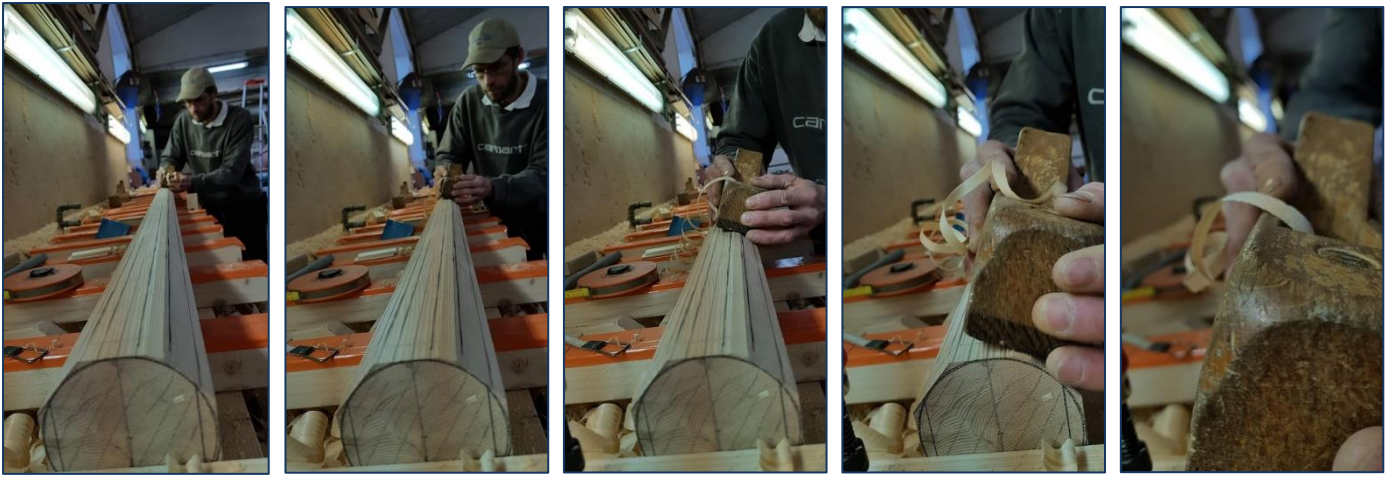
Utilisation de rabots anciens parfois modifiés pour les besoins.
